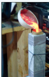
Versement de la coulée de bronze dans un moule
